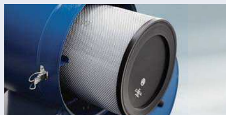
Простота обслуживания: элемент воздушного фильтра Aergen
