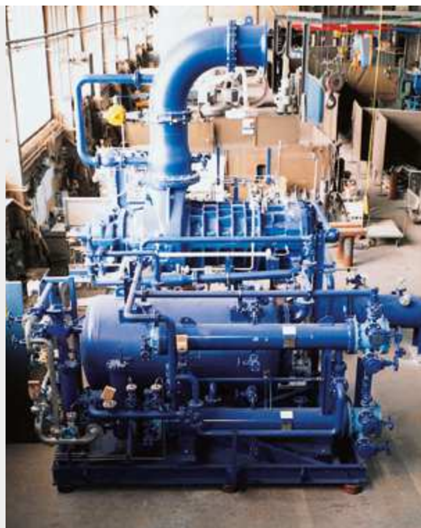
Soda Sanayi, г. Мерсин (Турция), установка сжатия отходящих газов печи обжига известняка VRO 836 L, объем всасывания 45 000 м 3 /ч, сжатие в диапазоне 0,85 - 3,5 бар (абс.). Гидроизолированное лабиринтное уплотнение с графитовыми кольцами.
