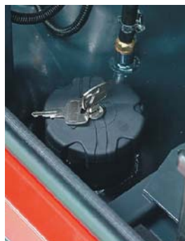
Запираемая горловина топливного бака
